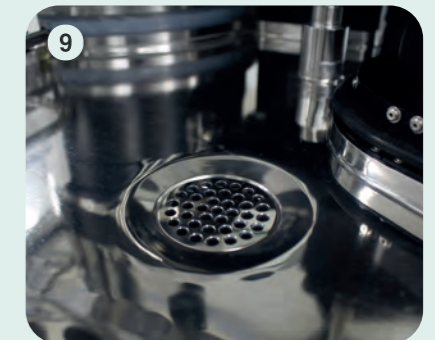
1.HMI, 2. Containment-Ventil, 3. Handschuhports, 4. RTP, 5. Geschweißte Wand, Schwelle und Schlauchdichtung für Türen, 6. Reinigungsdüsen, Wasserpistole und Luftpistole, 7. Silikonabdichtung für bewegliche Teile 8. Vorrichtung für demontierte Teile, 9. Abfluss und schräger Boden
